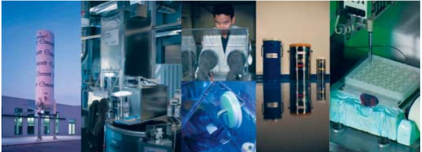
Abbildung 1: Von links nach rechts: Forschungs- und Demonstrationskryobank EurocryoSAAR, »Schleusenturm« für Stickstofflagertanks zur geschützten Ein- und Auslagerung, Fraunhofer-Schutzhaubentechnik für Kryoprobenmanipulation, kundenspezifische Tieftemperatur-Transportbehälter, Automatisierung von Kryopräparationschritten (U. Schön und C. Durst, IBMT).
