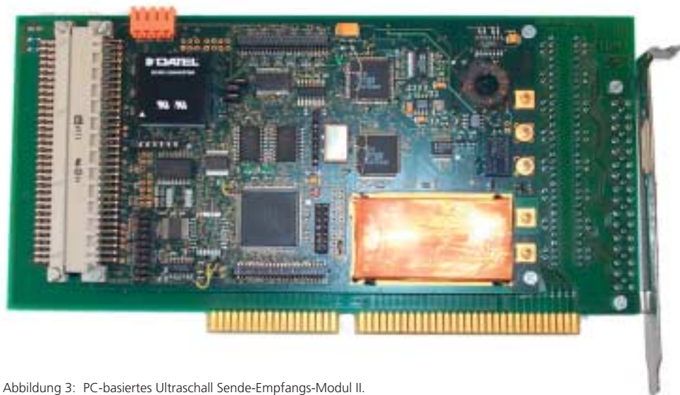
Abbildung 3: PC-basiertes Ultraschall Sende-Empfangs-Modul II.
