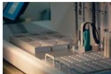
Abbildung 1: Hochdurchsatz-Syntheseautomat LIPS® Synthesizer 9 x 384.
