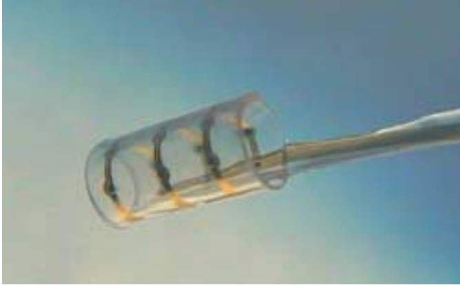
Abbildung 2: Manschetten-Elektrode aus Polyimid mit Verstärkung aus Silikon. Bauform mit 18 integrierten Elektroden. Anwendungsszenario: Schnittstelle zu peripheren Nerven ohne Traumatisierung des Nerven.
